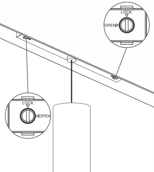
**4** Установка завершена, светильник готов к эксплуатации.
