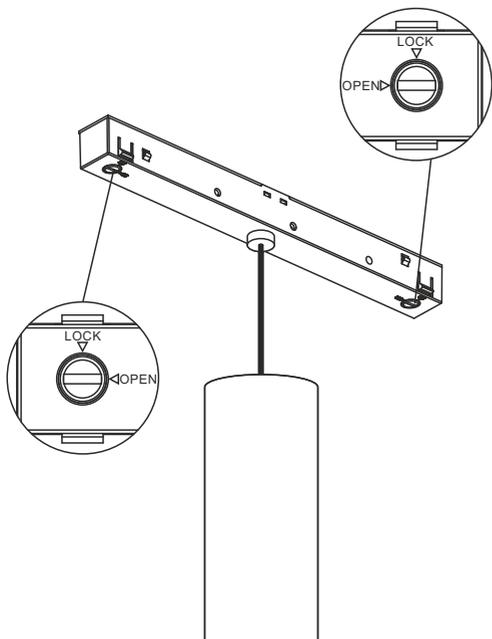
**2** Установите адаптер светильника в шинопровод до щелчка
