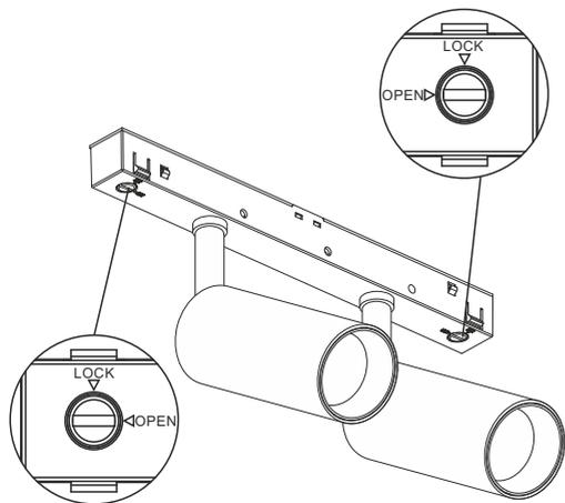
**2** Установите светильник в шинопровод до щелчка
