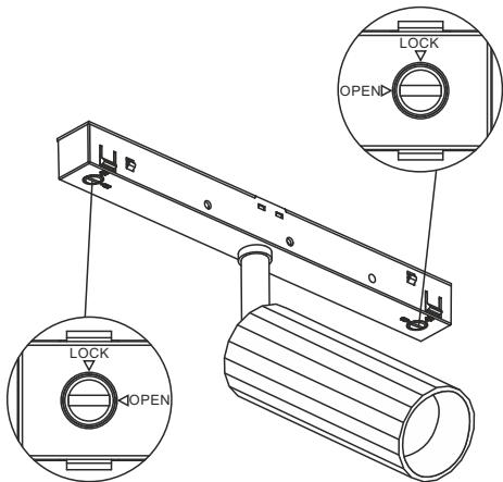
**2** Установите светильник в шинопровод до щелчка
