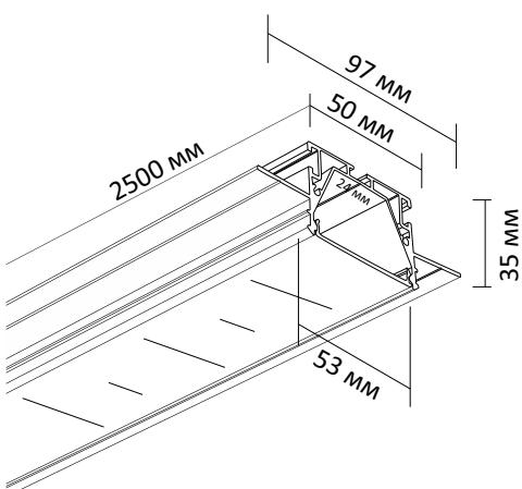
Комплект алюминиевого профиля LINEAR 5335 F предназначен для освещения при помощи интеграции в него светодиодной ленты.
