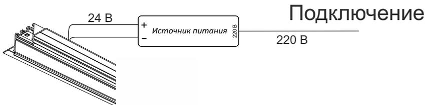
Источник питания устанавливается за пределами корпуса профиля в электромонтажном шкафу
